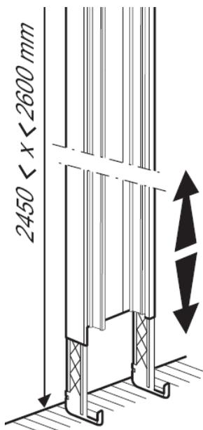
L'installation du pied compensateur permet un réglage en hauteur compris entre 2450 et 2600mm
