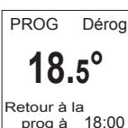
Vous pouvez modifier la température ECO, vous forcez donc le réglage par défaut entre la température Confort et la température Eco. «PROG Dérog» s'afficheé jusqu'à la prochaine plage Confort.
