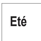
En diminuant la température au minimum, vous passez en mode Eté, votre appareil ne chauffe plus. La fonction Boost reste accessible.
